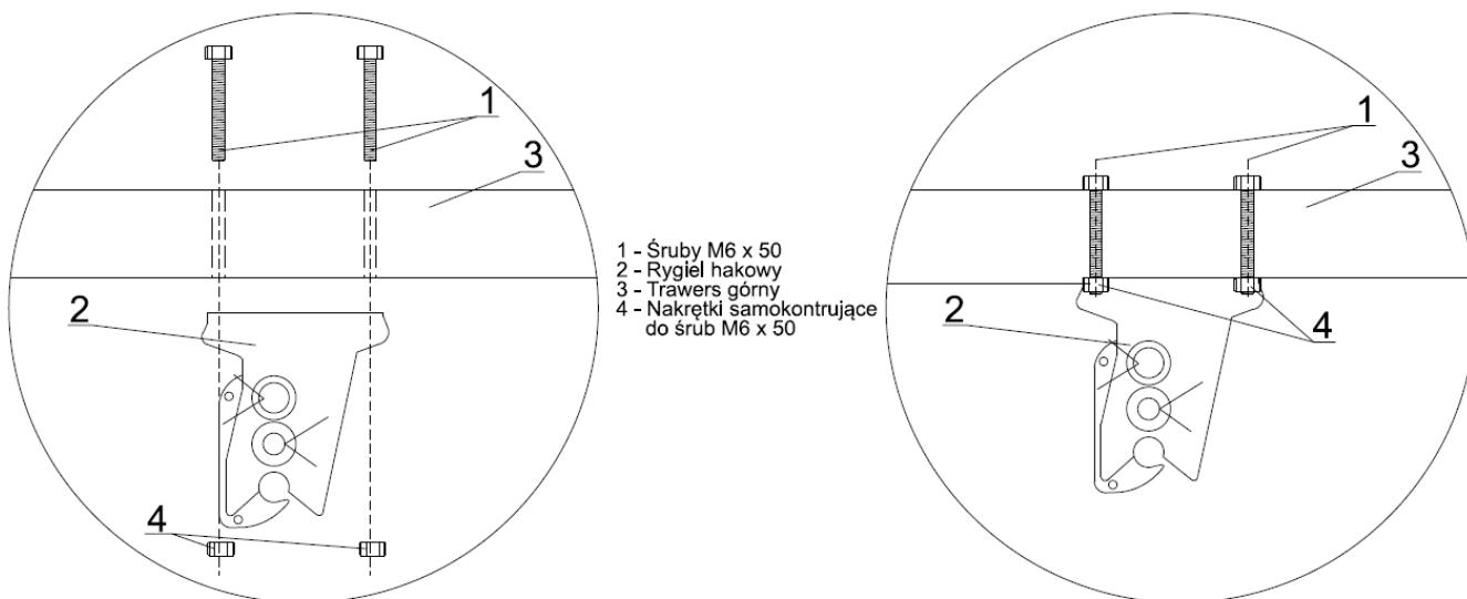
Rys. 20. Montaż rygla hakowego
